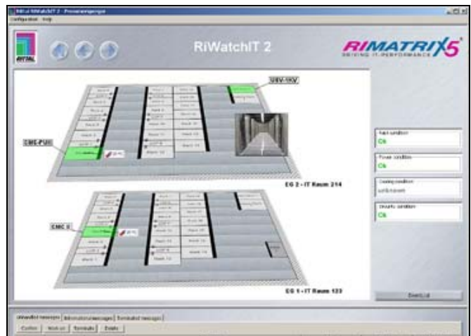
Модуль просмотра позволяет визуализировать все важные активные компоненты, например ИБП, датчики СМС-ТС и систему PSM.
